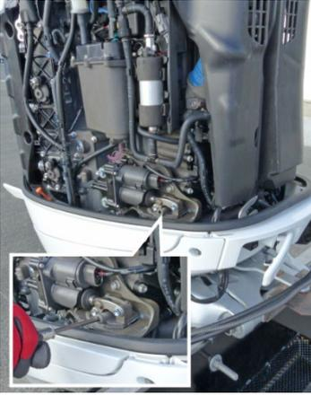
4. Insérez le tournevis cruciforme avec la poignée de la trousse à outils dans le trou de l'actionneur de changement de vitesse.
